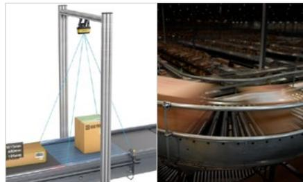
La capacidad de instantáneas en movimiento permite la adquisición rápida de imágenes (sin necesidad de codificador) que supera las transiciones irregulares, cambios de velocidad y transportadores curvos.
