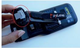
4. Introduzca la batería en la ranura, primero la parte superior, y presione hasta que encaje.
