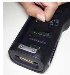
3. Deslice el soporte para tarjeta hacia la derecha y luego tire de él hacia arriba.
