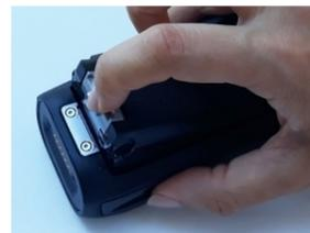
2. Retire la tapa de la ranura de la tarjeta microSD.
