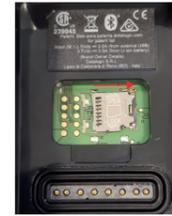
4. Inserte la tarjeta microSD en el soporte; empuje el soporte de tarjeta hacia abajo y luego deslícelo hacia la izquierda.
