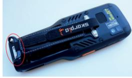
3. Conecte el puente inferior para la correa de mano con la batería.
